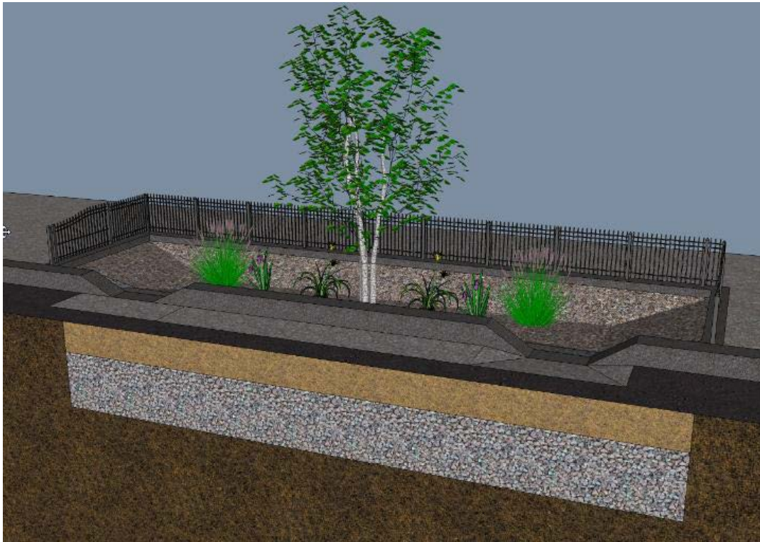
Figura 21.- Zanja de infiltración Fuente: NYC Green Infrastructure 2010
