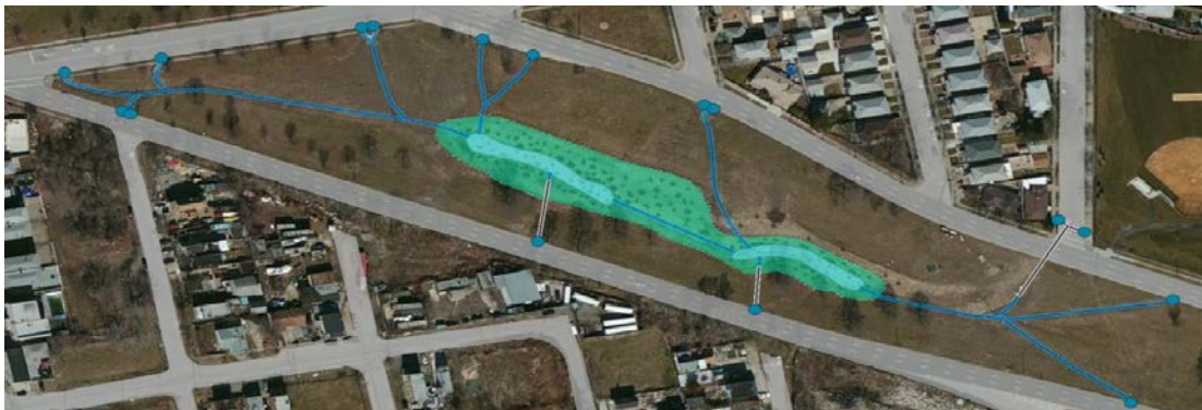
Figura 22.- Depósito de detención Fuente: NYC Green Infrastructure 2010
